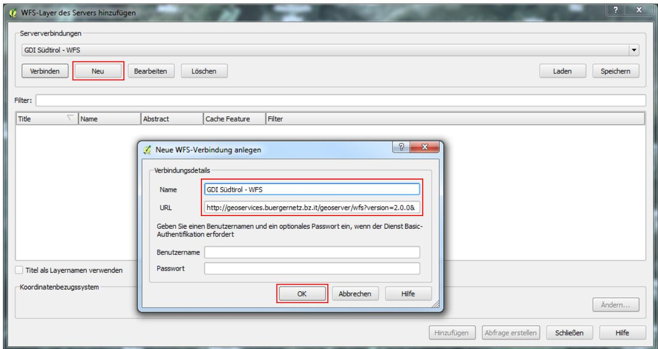
Figura 10. Creazione di un nuovo collegamento WFS.
